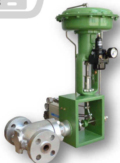
Fig. 18: Válvula de control EHZ Ø1" 1500# con actuador tipo 530, Cv máx. 0,025, internos Mini Forma en carburo de tungsteno.
