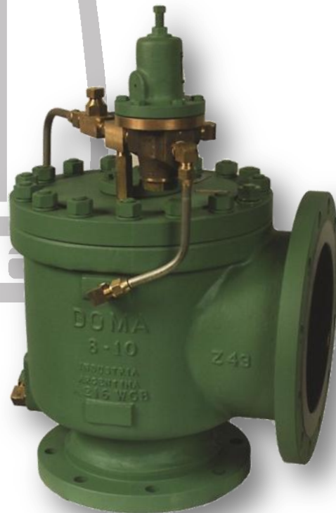
Fig. 16: DAP Ø8" 150# - T - 10" 150# con piloto 198H y restricción 111L (diseño con tobera semi-completa).
